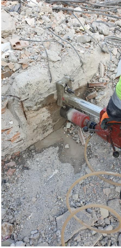
6-A: 4 Numaralı Numunenin Alınma Aşaması
