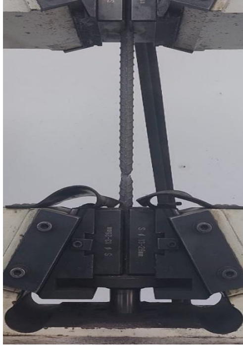
Resim 13: Grand Isias Otel Enkazından Alınan Çelik Çubukların Deney Aşamaları
