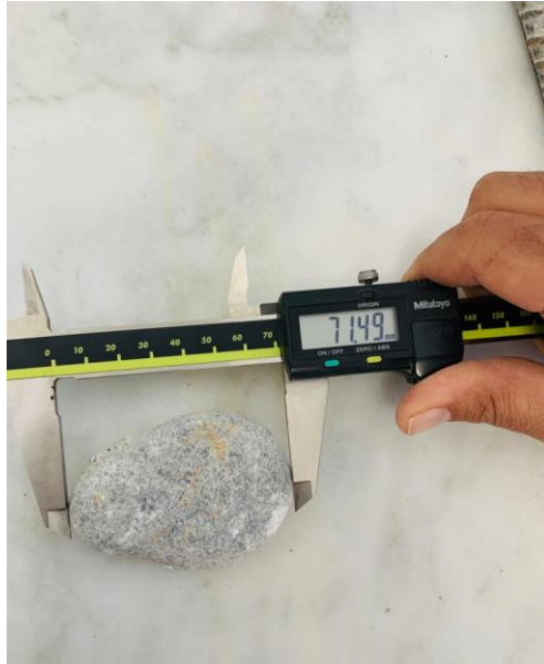
Resim 14: Grand Isias Otel Enkazından Alınan İri Agregaların Deney Aşamaları
