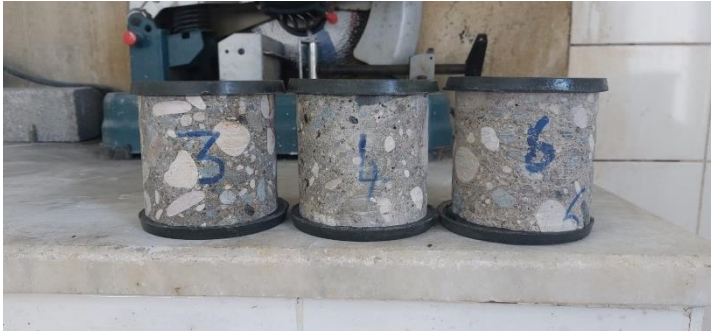
12-A: Deney için Hazırlanan Karot Numuneler
