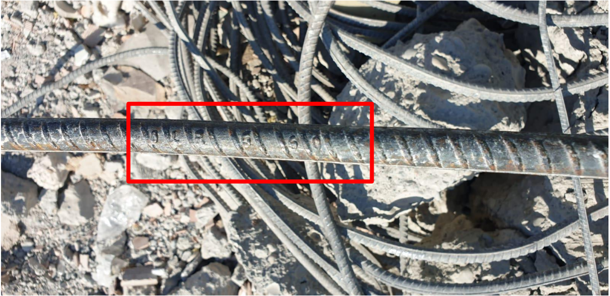
Resim 16: Grand Isias Otel Enkazında Tespit Edilen Nervürlü Çelik Çubuk Üzerindeki Markalama İşareti
